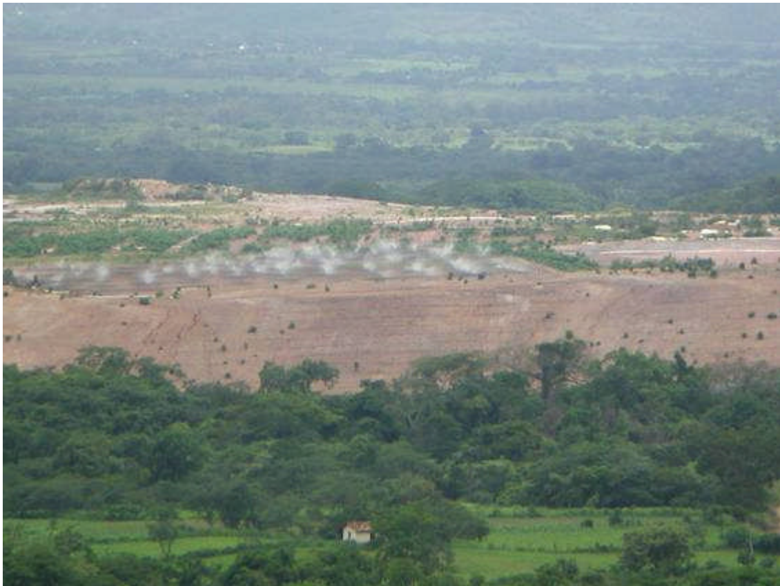
Foto 1 (Derechos en Acción). El sistema de regar cianuro encima de la roca y tierra, para que el cianuro separe el oro de lo demás.
